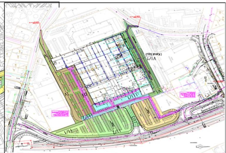
1.900 m Mischwasserkanal DN 200-800 PP u. Sb
